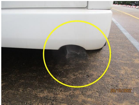
รูปที่ 25 อุปกรณ์ป้องกันประกายไฟจากท่อไอเสียรถยนต์
